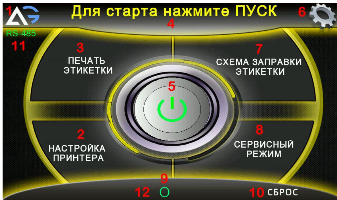
Рисунок. Основное меню принтера-аппликатора Н-ПР-01.
